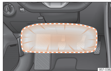
SL. 32 Na vozačevoj strani: područje djelovanja zračnog jastuka za koljena.
