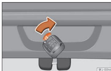
Sl. 87 Isječek iz prtljažnika: otključavanje u nuždi.
