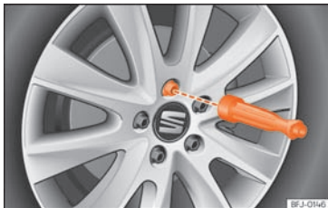
Sl. 39 Zamjena kotača: odvrtanje vijaka kotača pomoću ručice odvijača.
