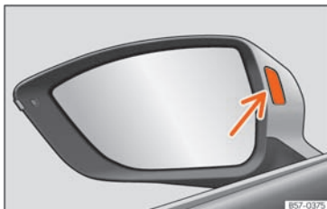
Sl. 194 Kontrolna žaruljica potpore pri promjeni voznog traka.
