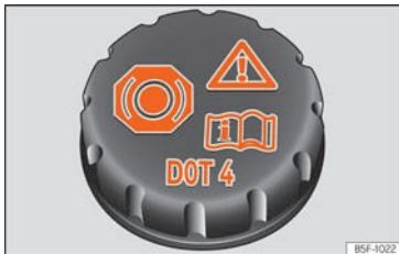
Sl. 246 Prostor motora: poklopac spremnika kočione tekućine.
