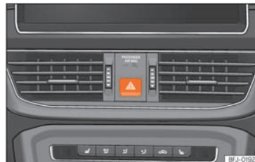
Sl. 95 Instrumentna ploča: prekidač uređaja za svjetlosno upozorenje.
