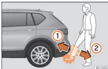
Sl. 86 Stražnji poklopac s funkcijom otvaranja pomoću senzora (Easy Open).
