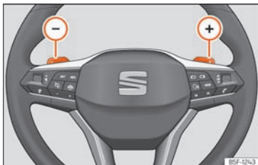
SL. 168 Kolo upravljača: ručica automatskog mjenjača.
