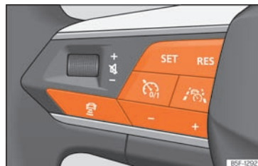
SL. 193 Lijeva strana višenamjenskog kola upravljača: tipke za rukovanje potporom Travel Assist.
