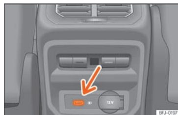
SL 160 Stražnja središnja konzola: USB priključci s funkcijom utičnice.
