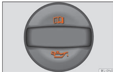
Sl. 242 Poklopac otvora za ulijevanje motornog ulja u prostoru motora
