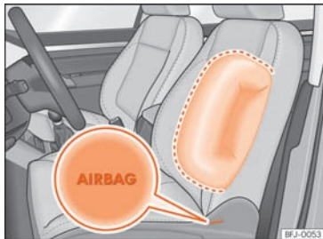
Sl. 21 Bočni zračni jastuk u vozačevom sjedalu
