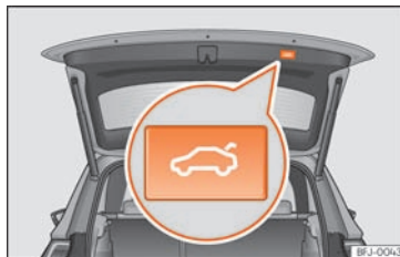
SL 84 Stražnji poklopac: tipka za zatvaranje stražnjeg poklopca.
