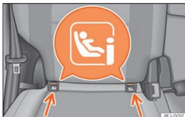
Sl. 26 Bočna mjesta za sjedenje drugog reda sjedala: ISOFIX/i-Size pričvršne ušice.
