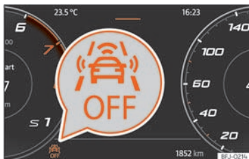
Sl. 183 Na zaslonu kombiniranog instrumenta: prikaz da je Front Assist isključen.
