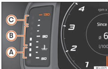
Sl. 61 Kombinirani instrument s mogućnošću slobodne konfiguracije: pokazivač temperature rashladnog sredstva motora.
