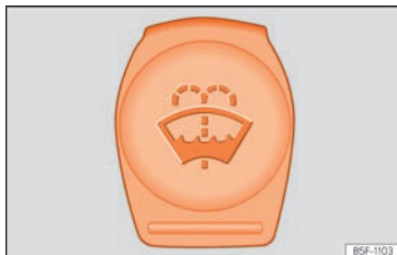
Sl. 247 U prostoru motora: poklopac spremnika tekućine za pranje stakla.
