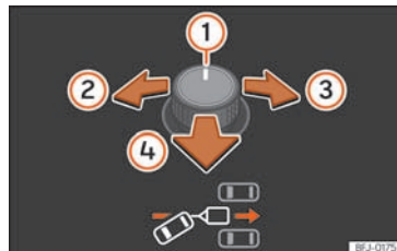
Sl. 212 Regulator za vanjska zrcala: namještanje smjera prikolice.
