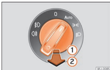
Sl. 93 Instrumentna ploča: prekidač za svjetla.
