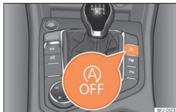
Sl. 163 Središnja konzola: tipka start-stop sustava.
