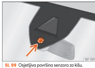
Sl. 99 Osjetljiva površina senzora za kišu.
