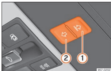
SL. 90 U krovnoj oblozi: tipke rolete za zaštitu od sunca.
