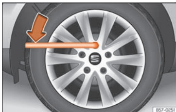
Sl. 35 Zamjena kotača: otpuštanje vijaka kotača.
