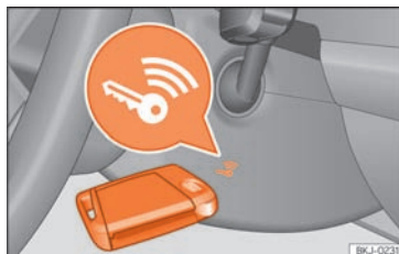
Sl. 162 Desno na stupu upravljača: pokretanje u nuždi.
