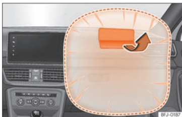
Sl. 16 Suvozačev zračni jastuk u instrumentnoj ploči
