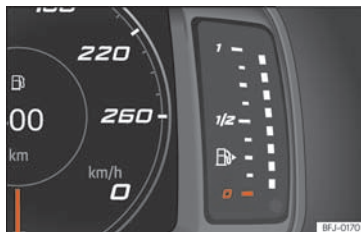
Sl. 60 Kombinirani instrument s mogućnošću slobodne konfiguracije: pokazivač zalihe goriva
