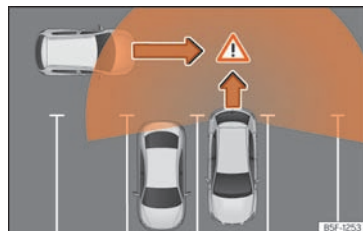
Sl. 198 Shematski prikaz potpore izlaska iz parkirnog mjesta: nadzirano područje parkirnog vozila.
