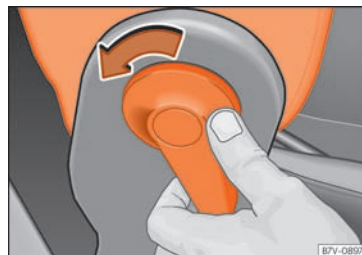
SI. 113 Deblokiranje preklopnog naslona suvozačevog sjedala.
