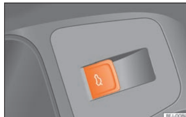
SL 85 U vozačevim vratima: tipka za otvaranje i zatvaranje stražnjeg poklopca.
