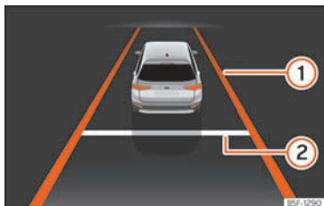
SL. 191 Na zaslonu kombiniranog instrumenta: prikaz kod aktivne regulacije.
