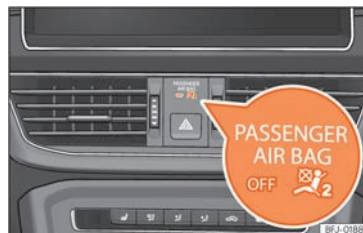
Sl. 18 Instrumentna ploča: kontrolna žaruljica za isključivanje suvozačevih zračnih jastuka.
