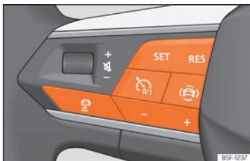
Sl. 185 Na višenamjenskom kolu upravljača: tipke za rukovanje sustavom ACC
