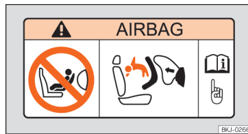
Sl. 24 Naljepnica zračnog jastuka: na zaslonu za sunce na suvozačevoj strani
