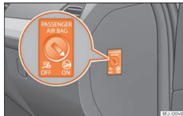
Sl. 17 Bravica za aktiviranje i deaktiviranje suvozačevog zračnog jastuka.
