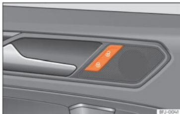
Sl. 76 Vozačeva vrata: tipka centralnog zaključavanja.
