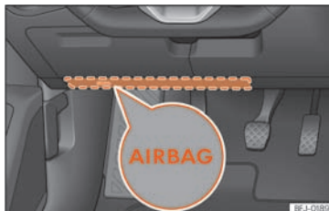
Sl. 19 Na vozačevoj strani: mjesto ugradnje zračnog jastuka za koljena.
