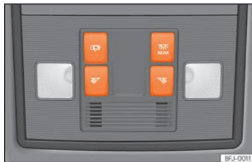
SL 96 Isječak iz krovne obloge: osvjetljenje unutrašnjeg prostora sprijeda.
