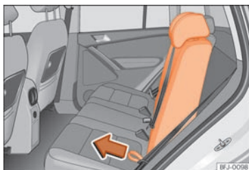
Sl. 114 Preklapanje i podizanje naslona stražnjeg sjedala.
