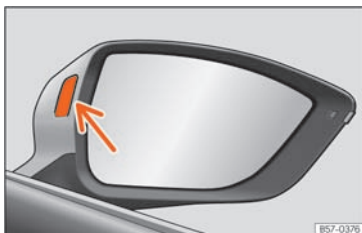
Sl. 195 Kontrolna žaruljica potpore pri promjeni voznog traka.
