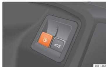
Sl. 234 Vozačeva vrata: otključavanje poklopca spremnika za gorivo.
