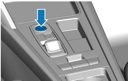
Drücken Sie den START-ENGINE-STOP-Knopf in der Mittelkonsole, ohne das Bremspedal zu betätigen.
