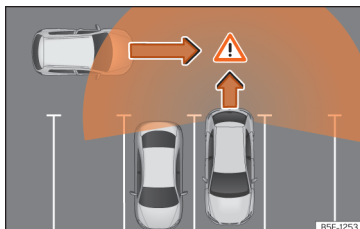
Sl. 164 Shematski prikaz potpore izlaska iz parkirnog mjesta: nadzirano područje parkirnog vozila.
