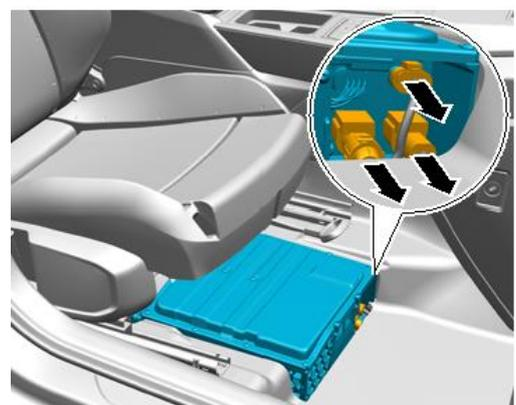
Bei Unfällen mit Airbagauslösung wird die 48 Volt Fahrzeugelektrik automatisch deaktiviert.
