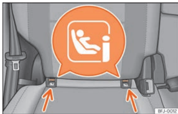
SL 41 Stražnje sjedalo: mjesto ugradnje ISOFIX ili i-Size pričvrtnih ušica.
