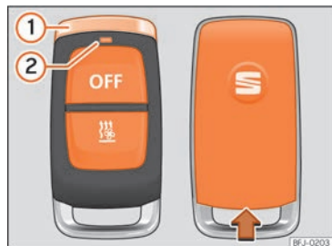
SL 117 Grijanje vozila u mirovanju: daljinski upravljač na radiosignal
