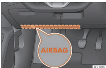
SL. 36 Na vozačevoj strani: mjesto ugradnje zračnog jastuka za koljena.
