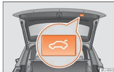
Sl. 76 Stražnji poklopac: tipka za zatvaranje stražnjeg poklopca.
