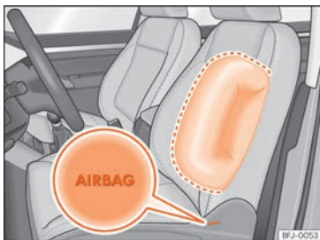
Sl. 34 Bočni zračni jastuk u vozačevom sjedalu
