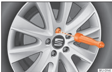
Sl. 256 Zamjena kotača: odvrtanje vijaka kotača pomoću ručice odvijača.
