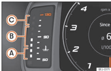
Sl. 10 Digitalni kombinirani instrument SEAT Digital Cockpit: Pokazivač temperature rashladnog sredstva motora.
