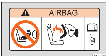
Sl. 39 Etiketa zračnog jastuka: na zaslonu za sunce na suvozačevoj strani.
