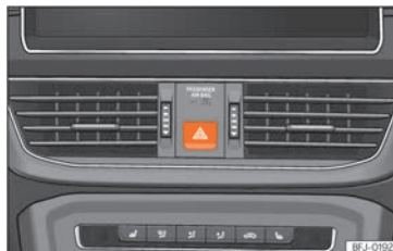
Sl. 49 Instrumentna ploča: prekidač uređaja za svjetlosno upozorenje
