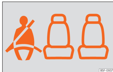
SL. 22 Kombinirani instrument: prikaz statusa vezanja pojasa za stražnja mjesta za sjedenje.
