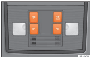
SL 106 Dio krovne obloge: osvjetljenje unutrašnjosti sprijeđa.
