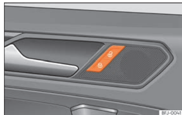
SL. 70 U vozačevim vratima: tipka centralnog zaključavanja.
