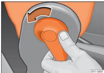
Sl. 90 Deblokiranje naslona suvozačevog sjedala s mogućnošću preklapanja.
