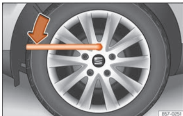
Sl. 252 Zamjena kotača: otpuštanje vijaka kotača
