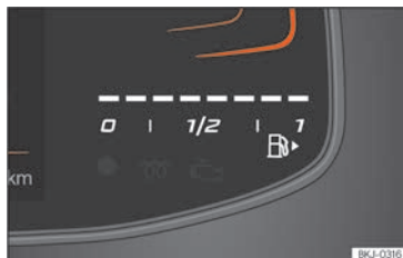
Sl. 6 Kombinirani instrument Basic: pokazivač zalihe goriva.
