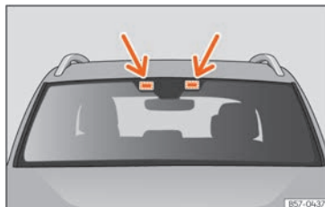
SL.116 Područja za postavljanje elektroničke dodatne opreme
