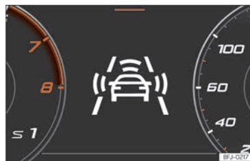
Sl. 144 Na zaslonu kombiniranog instrumenta: napomene za prethodno upozorenje.
