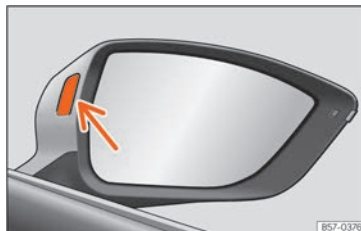
SL. 151 Kontrolna žaruljica potpore pri promjeni voznog traka.
