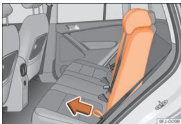
SL. 93 Preklapanje i podizanje naslona stražnjeg sjedala.
