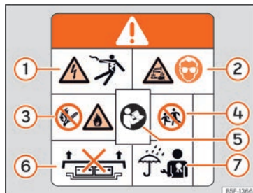
SL 52 Znak upozorenja na visokonaponskoj bateriji.
