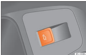
SL 77 U vozačevim vratima: tipka za otvaranje i zatvaranje stražnjeg poklopca.
