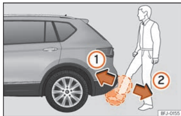
SL 78 Stražnji poklopac s funkcijom otvaranja pomoću senzora (Easy Open).
