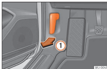
Sl. 232 Ručica za deblokiranje u vozačevom prostoru za noge.
