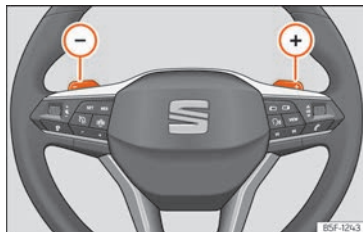
Sl. 125 Kolo upravljača: ručice za automatski mjenjač.
