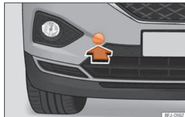
Sl. 224 Na desnoj strani prednjeg branika: skidanje poklopca.
