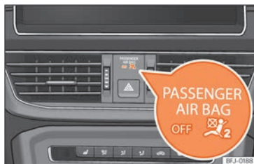
Sl. 33 Instrumentna ploča: kontrolna žaruljica za isključeni suvozačev zračni jastuk.
