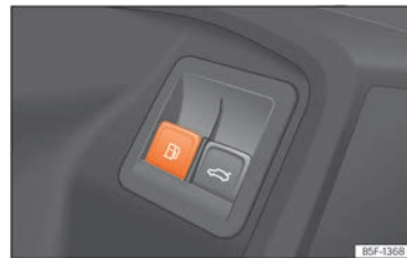
Sl. 215 Vozačeva vrata: otključavanje poklopca spremnika za gorivo.
