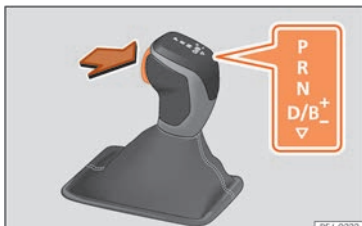
Sl. 124 blokada ručice automatskog mjenjača (hibridna vozila).
