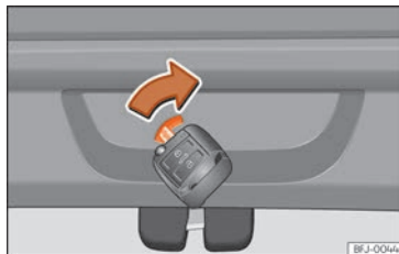
SL. 79 Isječak iz prtljažnika: otključavanje u nuždi.
