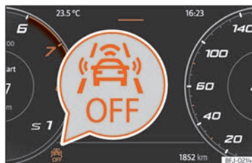
Sl. 146 Na zaslonu kombiniranog instrumenta: prikaz da je Front Assist isključen.
