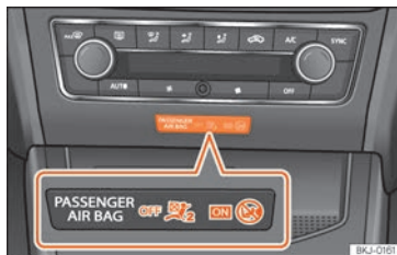
Sl. 28 Srednji dio instrumentne ploče: kontrolna žaruljica za isključeni suvozačev prednji zračni jastuk.
