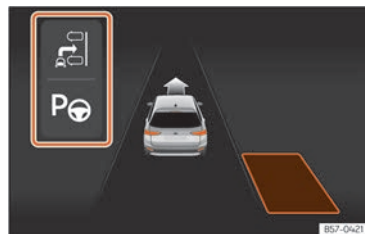
Sl. 124 Na ekranu kombiniranog instrumenta: prikaz potpore upravljanja pri parkiranju s ograničenom vidljivošću.
