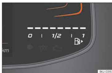
Sl. 3 Kombinirani instrument Basic: pokazivač zalihe goriva.
