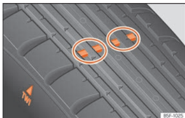
SL. 190 Profil gume: pokazivači istrošenosti.
