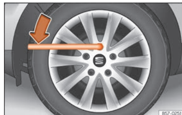
SL. 196 Zamjena kotača: otpuštanje vijaka kotača
