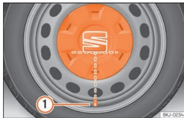
SL. 193 Ispravno postavljanje ukrasnog poklopca kotača za čelične naplatke.
