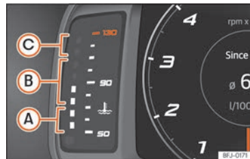
Sl. 6 Digitalni kombinirani instrument SEAT Digital Cockpit: Pokazivač temperature rashladnog sredstva motora.
