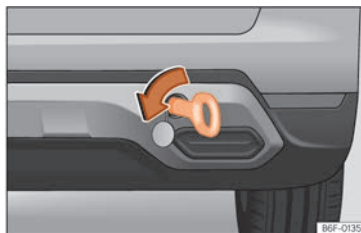
SL 167 Na desnoj strani stražnjeg branika: Zavrnutu ušicu za vuču.
