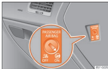
Sl. 29 Bravica za uključivanje i isključivanje suvozačevog zračnog jastuka.
