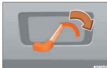
SL 64 Isječak iz prtljažnika: otključavanje u nuždi.
