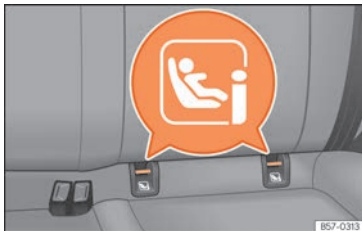
SL 39 Stražnje sjedalo: mjesto ugradnje ISOFIX ili i-Size pričvrtnih ušica.
