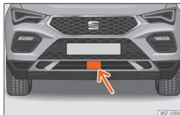
SL.108 U prednjem braniku: radarski senzor.
