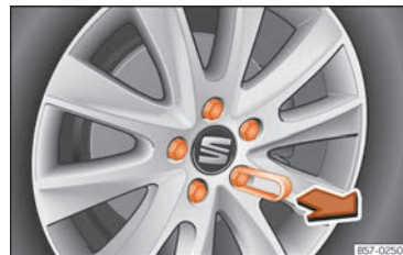
Sl. 220 Kotač: vijci kotača s kapicama.
