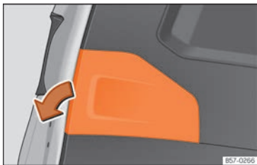
Sl. 201 Otvoren stražnji poklopac: skidanje poklopca.
