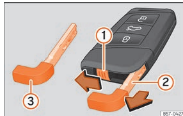
Sl. 48 Ključ vozila: izvlačenje pomoćnog ključa.
