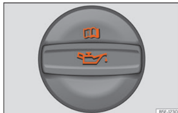
Sl. 225 Poklopac otvora za ulijevanje motornog ulja u prostoru motora
