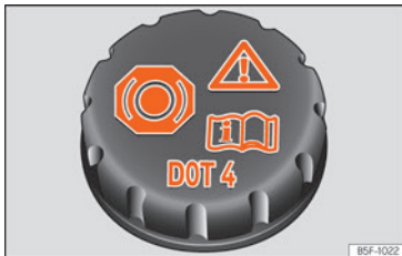
Sl. 229 Prostor motora: poklopac spremnika kočione tekućine.
