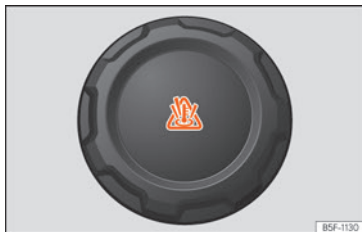
Sl. 228 Prostor motora: poklopac kompenzacijskog spremnika rashladnog sredstva motora.
