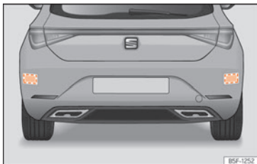
Sl. 170 Prikaz vozila straga: područja radarskih senzora.
