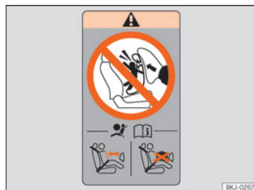
Sl. 31 Najlepnicu zračnog jastuka: u stražnjem okviru suvozačevih vrata
