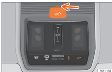
Sl. 37 U krovnoj konzoli: prekidač za govorne usluge
