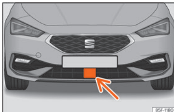
SL. 167 Na prednjem braniku: radarski senzor.
