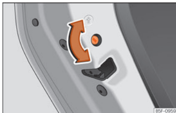
Sl. 91 Osigurač za djecu u lijevim vratima
