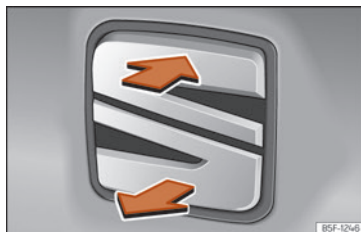
Sl. 92 Stražnji poklopac: otvaranje izvana.
