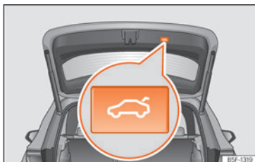
Sl. 93 Stražnji poklopac: tipka za zatvaranje stražnjeg poklopca.
