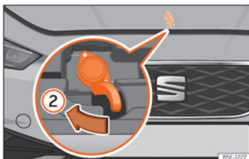
Sl. 222 Ručica ispod poklopca prostora motora.
