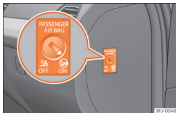
Sl. 20 Bravica za aktiviranje i deaktiviranje suvozačevog zračnog jastuka.
