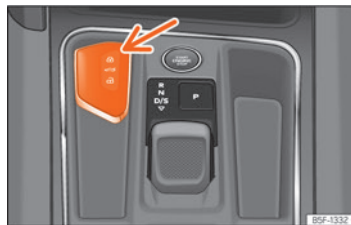
Sl. 81 Središnja konzola: prihvat za ključ vozila
