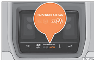
Sl. 21 U krovnoj konzoli: kontrolna žaruljica za isključivanje suvozačevih zračnih jastuka.
