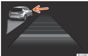
SL. 181 Na zaslону kombiniranog instrumenta: ACC aktivan, prepoznato vozilo na lijevoj strani
