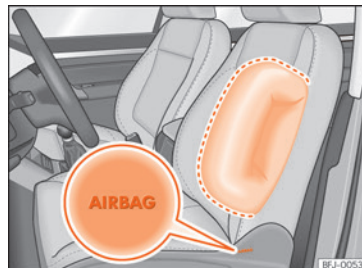
Sl. 26 Bočni zračni jastuk u vozačevom sjedalu
