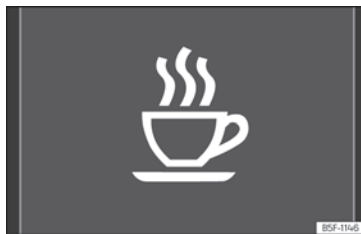
Sl. 62 Na zaslonu kombiniranog instrumenta: simbol sustava prepoznavanja umora.
