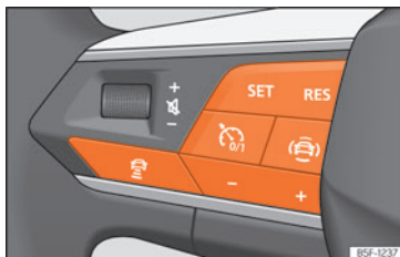
Sl. 179 Na višenamjenskom kolu upravljača: tipke za rukovanje sustavom ACC
