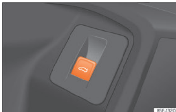
Sl. 94 U vozačevim vratima: tipka za otvaranje i zatvaranje stražnjeg poklopca.
