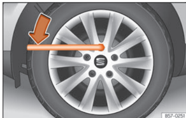
Sl. 43 Zamjena kotača: otpuštanje vijaka kotača.
