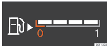
Sl. 68 Kombinirani instrument s mogućnošću slobodne konfiguracije: pokazivač zalihe goriva na različitim mjestima ovisno o prikazu.
