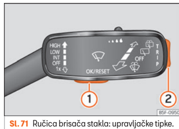
sl. 71 Ručica brisača stakla: upravljačke tipke.
