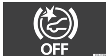
Sl. 178 Na zaslonu kombiniranog instrumenta: prikaz da je Front Assist isključen.
