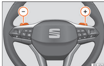
Sl. 166 Kolo upravljača: ručica automatskog mjenjača.
