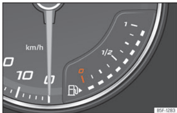
Sl. 67 Analogni kombinirani instrument: pokazivač zalihe goriva
