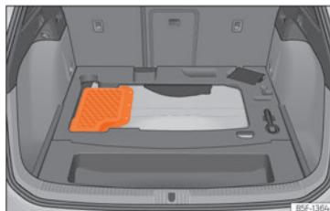
Sl. 231 Mjesto ugradnje akumulatora u prtljažniku
