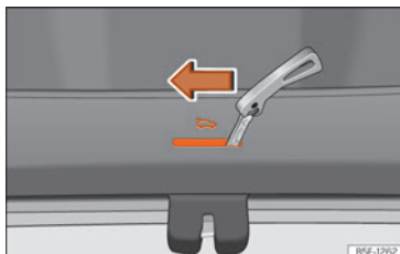
Sl. 96 Detalj prtljažnika: mehanizam za otključavanje u nuždi (Leon).
