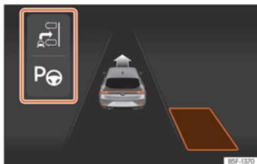
Sl. 197 Na zaslону kombiniranog instrumenta: prikaz potpore upravljanja pri parkiranju s ograničenom vidljivošću.
