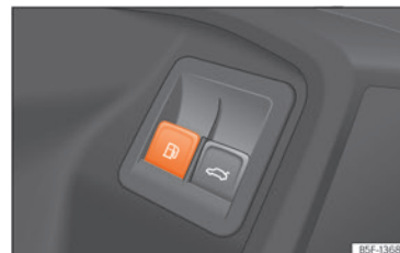
Sl. 217 Vozačeva vrata: otključavanje poklopca spremnika za gorivo.
