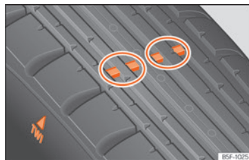
Sl. 235 Profil gume: pokazivači istrošenosti.
