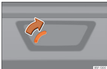
Sl. 97 Isječak iz prtljažnika: mehanizam za otključavanje u nuždi (Leon Sportstourer).
