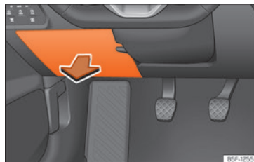
Sl. 55 Na vozačevoj strani u instrumentnoj ploči: poklopac kutije s osiguračima.
