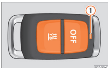
Sl. 151 Grijanje vozila u mirovanju: daljinski upravljač na radiosignal.
