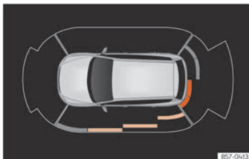
Sl. 121 Prikaz pomoći pri parkiranju na ekranu infotainment sustava.
