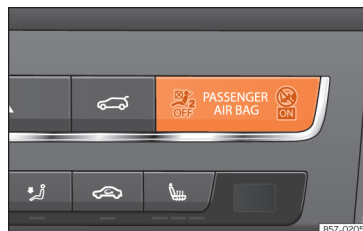
Sl. 17 Instrumentna ploča: kontrolna žaruljica za isključivanje suvozačevih zračnih jastuka.
