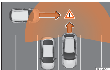
Sl. 193 Shematski prikaz potpore izlaska iz parkirnog mjesta: nadzirano područje parkiranja vozila.
