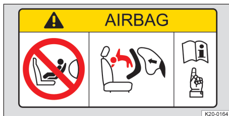
Sl. 1 Naljepnica za zračni jastuk na zaslonu za sunce (prikaz principa).
