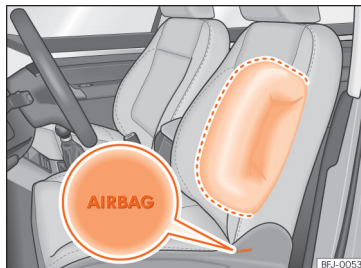
SL 32 Bočni zračni jastuk u vozačevom sjedalu
