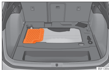
Sl. 235 Plug-in hibridna vozila (PHEV): mjesto ugradnje akumulatora u prtljažniku
