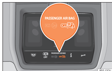
SL. 29 U krovnoj konzoli: kontrolna žaruljica za zračni jastuk na suvozačevoj strani isključena.
