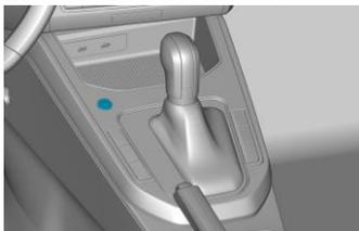
Wenn das Fahrzeug mit einem „Keyless-Entry“-System ausgestattet ist: Start- und Stopptaster drücken ohne das Bremspedal zu betätigen.
