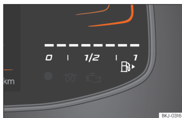
Sl. 3 Kombinirani instrument Basic: pokazivač zalihe goriva.
