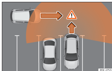
Sl. 161 Shematski prikaz potpore izlaska iz parkirnog mjesta: nadzirano područje parkiranog vozila.
