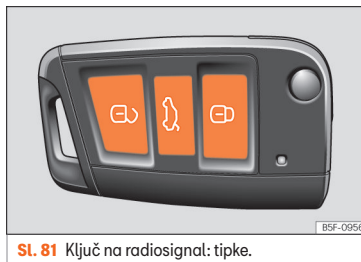
Sl. 81 Ključ na radijsignal: tipke.
