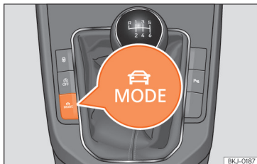
Sl. 138 Pored ručice mjenjača: tipka MODE.
