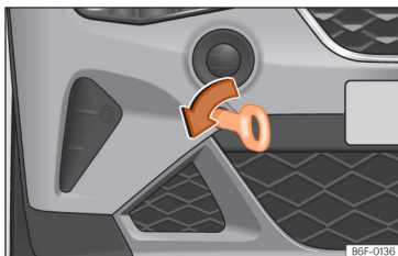
Sl. 45 Branik sprijeda desno: zavrnutu ušicu za vuču.
