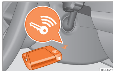
SL. 131 Desno na stupu upravljača: pokretanje u nuždi.
