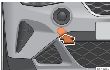
Sl. 44 Branik sprijeda desno: skidanje poklopca.
