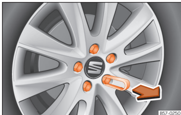
Sl. 33 Kotač: vijci kotača s poklopcem.
