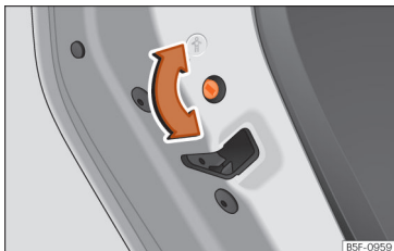
Sl. 88 Osigurač za djecu u lijevim vratima
