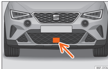
SL 139 Na prednjem braniku: radarski senzor.
