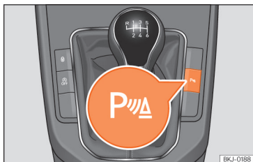
Sl. 170 Središnja konzola: tipka za pomoć pri parkiranju (ovisno o izvedbi).
